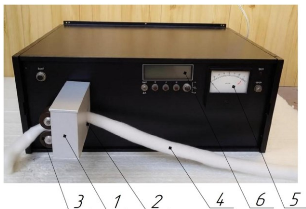
Рис. 2. Внешний вид установки для анализа плотности волокнистой ленты
