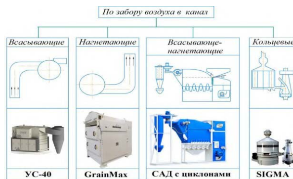
Рис. 6. Классификация зерноочистительных машин по забору воздуха в канал
