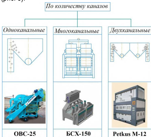
Рис. 5. Классификация зерноочистительных машин по количеству пневмоканалов
