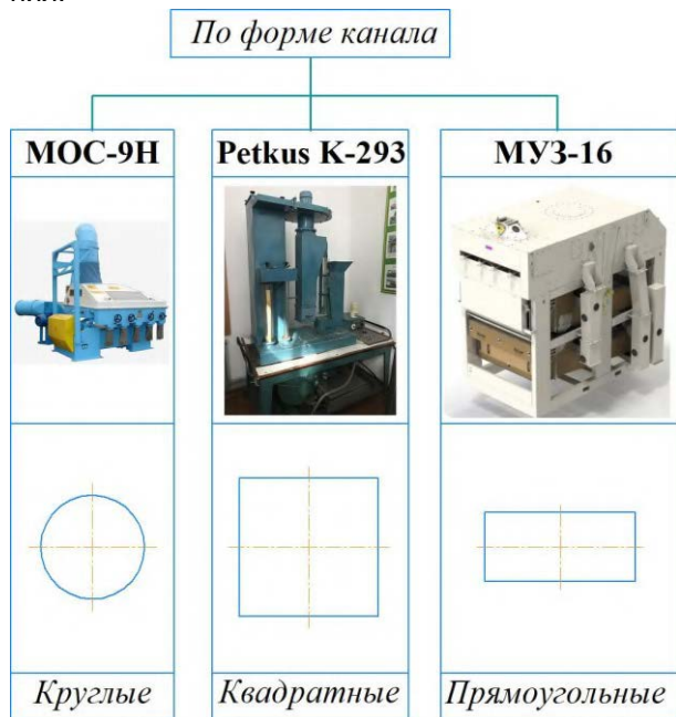
Рис. 3. Классификация зерноочистительных машин по форме воздушного канала
