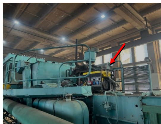
Рис. 4. Источник резервной мощности, установленный на зерноуборочный комбайн «Енисей 1200»:
