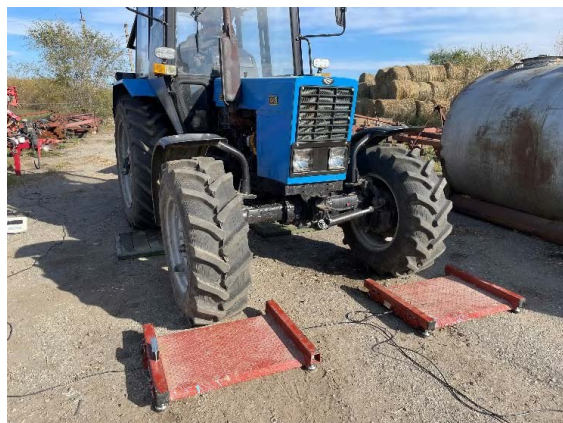
Рис. 2. Фрагмент измерения силового воздействия (нагрузки), приходящегося на опорные основания (двигатели) трактора Беларус 82.1
