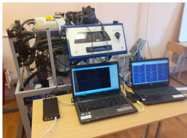
Рис. 2. Подключенное оборудование к технологическому стенду двигателя автомобиля
