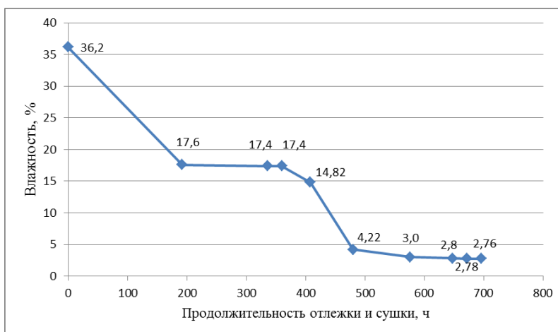
Рис. 11. Изменение влажности зерновки шалы риса прямого комбайнирования при естественной паротермической доработке и сушке (сорт Муса-2, 2024 г.)
