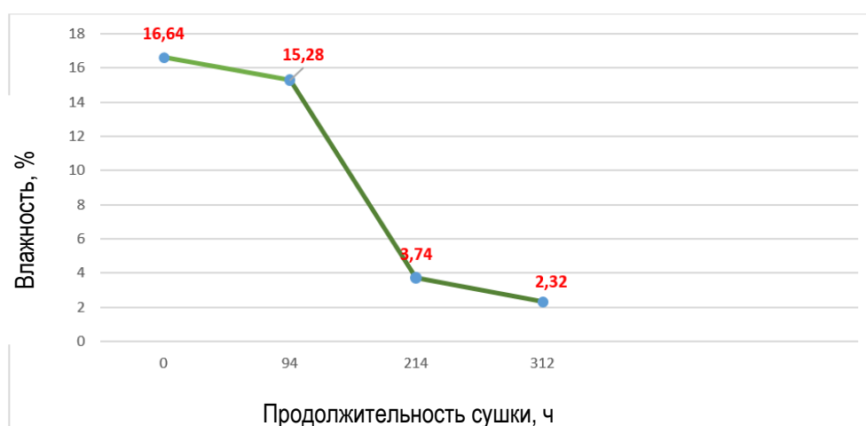
Рис. 7. Изменение влажности зерновки шалы риса ручной уборки при сушке в экспериментальной установке (сорт Муса): I – зона вентилирования (2 сут.), включения 1 тена (3 сут.) и 2 тенев (4 сут.) ( t_1 = 20^\circ\text{C} , v_1 = 65\% , t_2 = 21^\circ\text{C} , v_2 = 63\% , t_3 = 25^\circ\text{C} , v_3 = 60\% , t_n = 22,5^\circ\text{C} ); II – зона сушки в сушильной комплексе, включено 3 тена ( t = 30^\circ\text{C} , v = 55\% , t_n = 18,5^\circ\text{C} )
