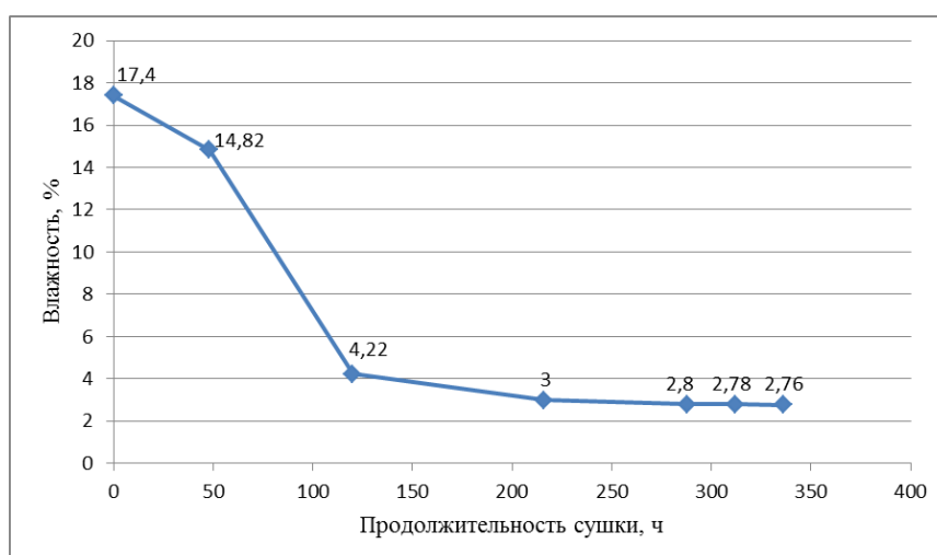
Рис. 10. Изменение влажности зерновки шалы риса в процессе сушки на экспериментальной установке (сорт Муса-2, 2024 г.)
