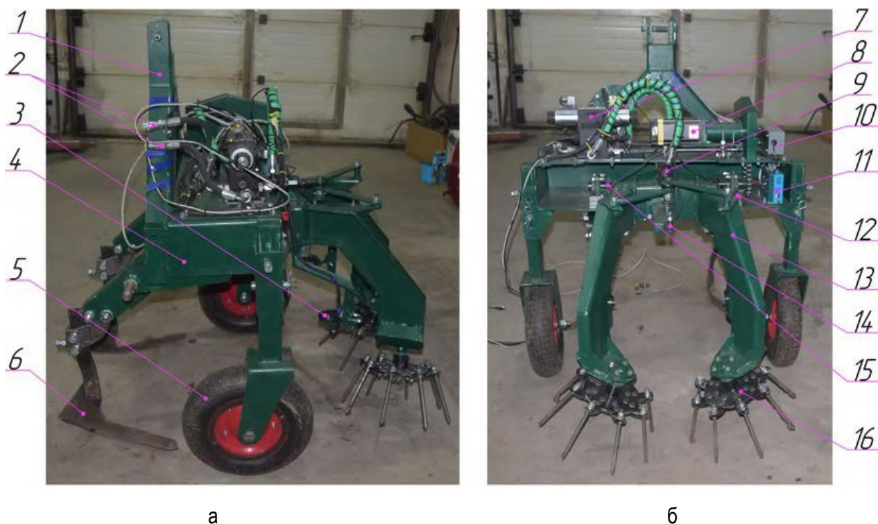
Рис. 6. Машина с автоматизированной системой управления рабочими органами для обработки почвы в плодopитомниках:
