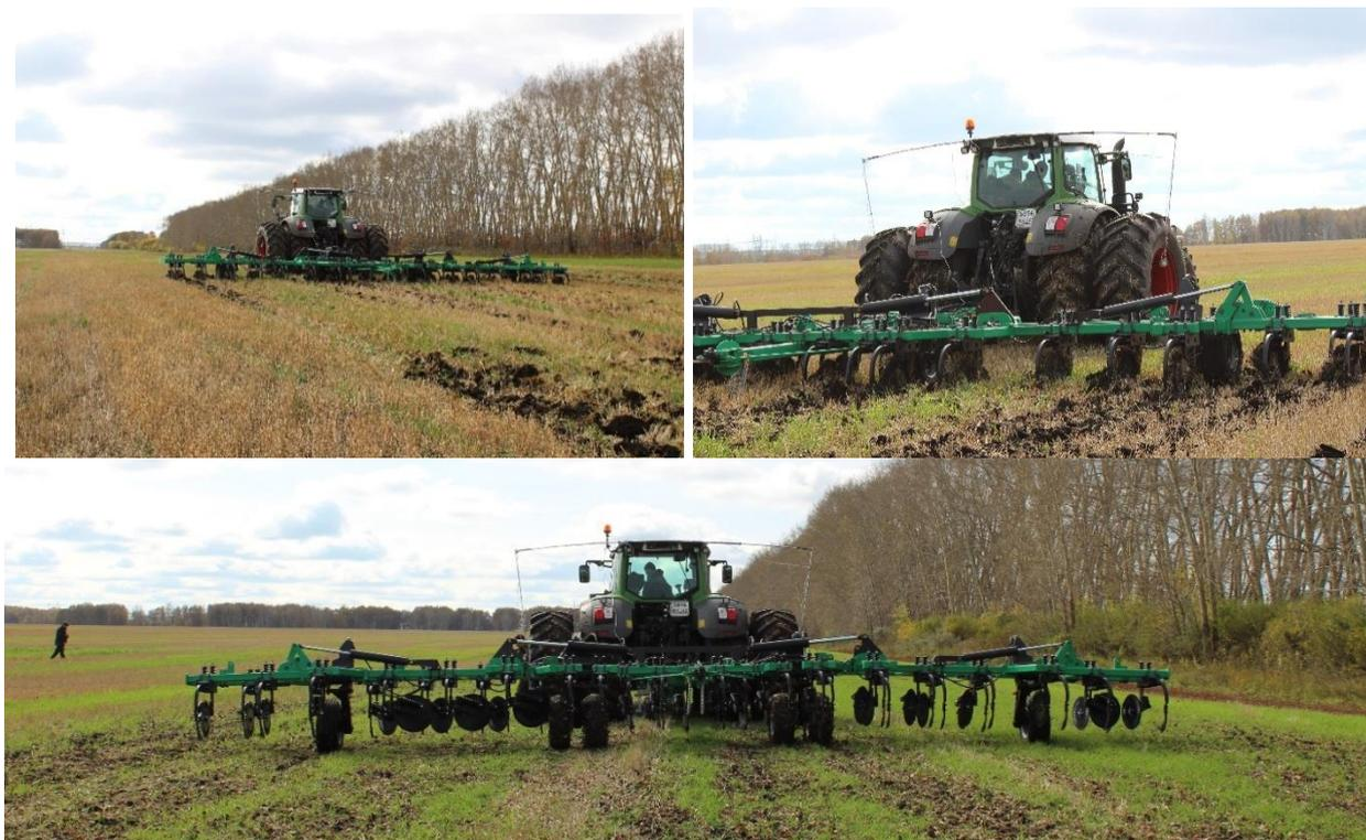
**Рис. 1. Агрегат для внесения безводного аммиака Fendt 936 Varjo+ ABA-12,6 на полевых испытаниях в режиме рыхлителя почвы**
