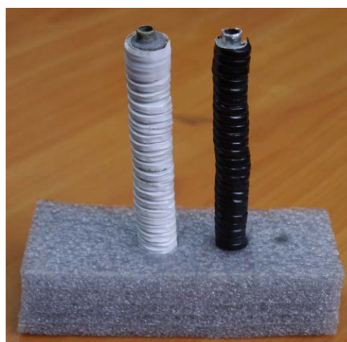
Рис. 1. Теплоизолированный топливopовод: чёрный – образец № 2; белый – образец № 3
