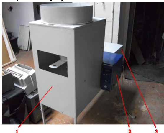
Рис. 3. Экспериментальная установка: 1 – блок подачи зерна; 2 – рабочая камера; 3 – выходной блок
