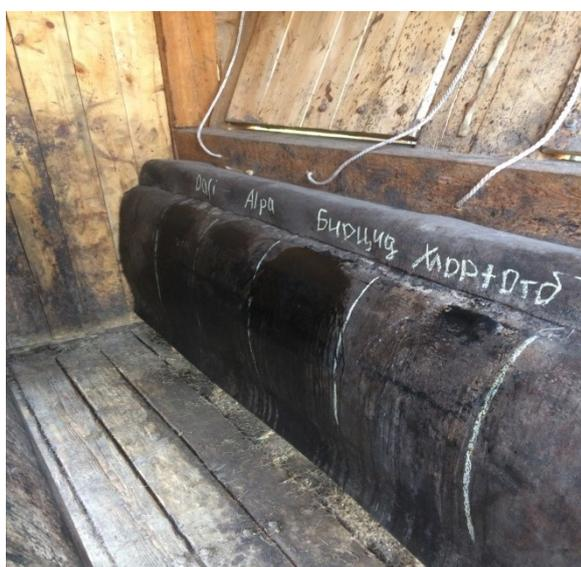
**Рис. Апробация фунгицидных растворов на поверхности панторезного станка**
