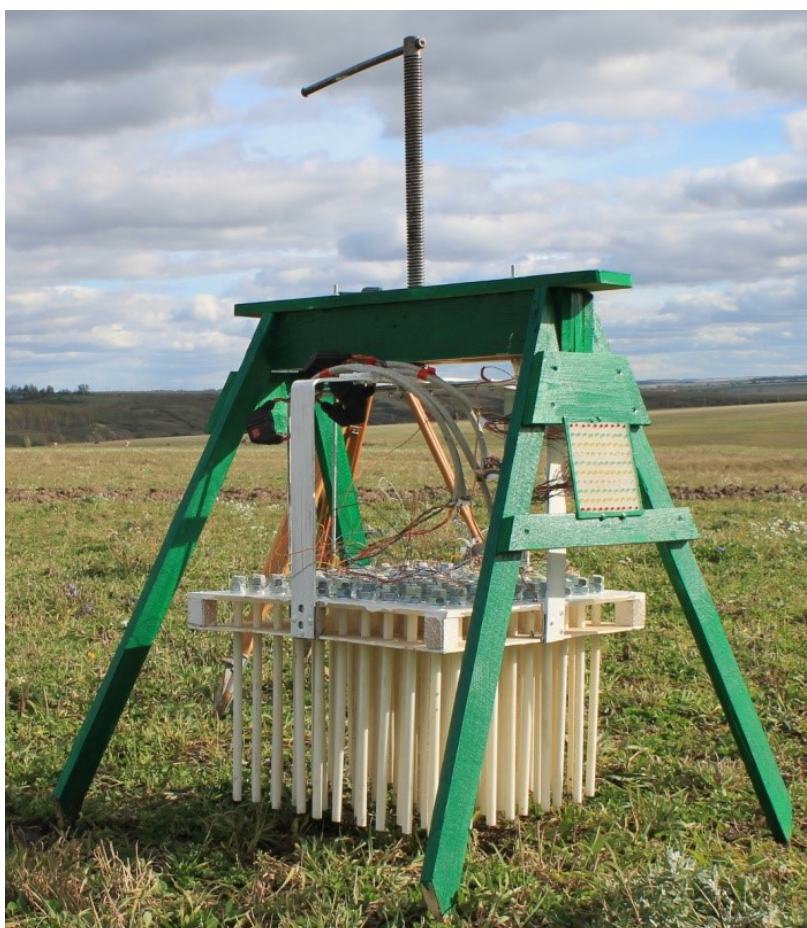
Рис. 1. Расположение устройства для профилирования поверхности почвы и определения направления стока атмосферных осадков в полевых условиях
