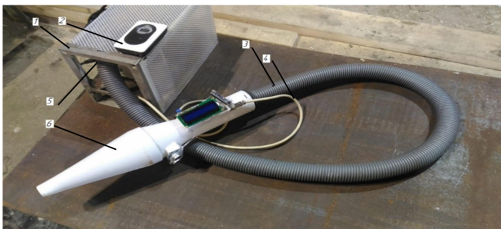
Рис. 1. Экспериментальная установка для сушки техники с многофункциональной ручкой: 1 – воздушный нагнетатель; 2 – цифровая метеостанция; 3 – воздушный шланг; 4 – электрический кабель; 5 – пульт управления; 6 – разборная многофункциональная ручка
