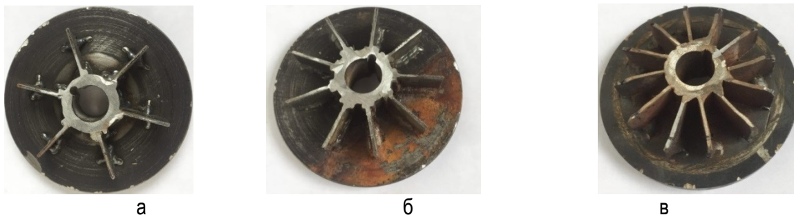
Рис. 1. Общий вид исследуемой крыльчатки дезинтегратора зерна: а – с 6 лопатками; б – с 9 лопатками; в – с 12 лопатками
