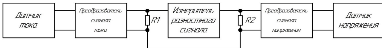
Рис. 1. Упрощённая принципиальная схема устройства измерения сдвига фаз между током и напряжением
