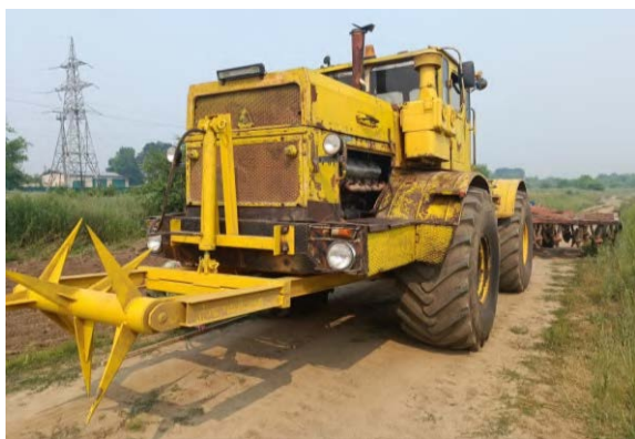
Рис. 1. Общий вид МТА (К-700А+ БДМ-6х4п + прокальватель-щелерез)
