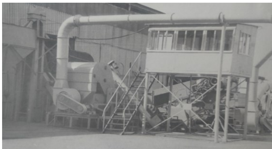
Рис. 3. Стационарная линия, включающая дозатор, роторную молотильно-сепарирующую установку МСУ-15, блок очистки семян БО-12 и пневмоконвейеры
