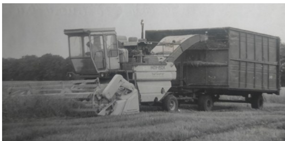
Рис. 1. Общий вид полевой машины МПУ-150 при скашивании стеблестоя люцерны и погрузки массы в тракторный прицеп
