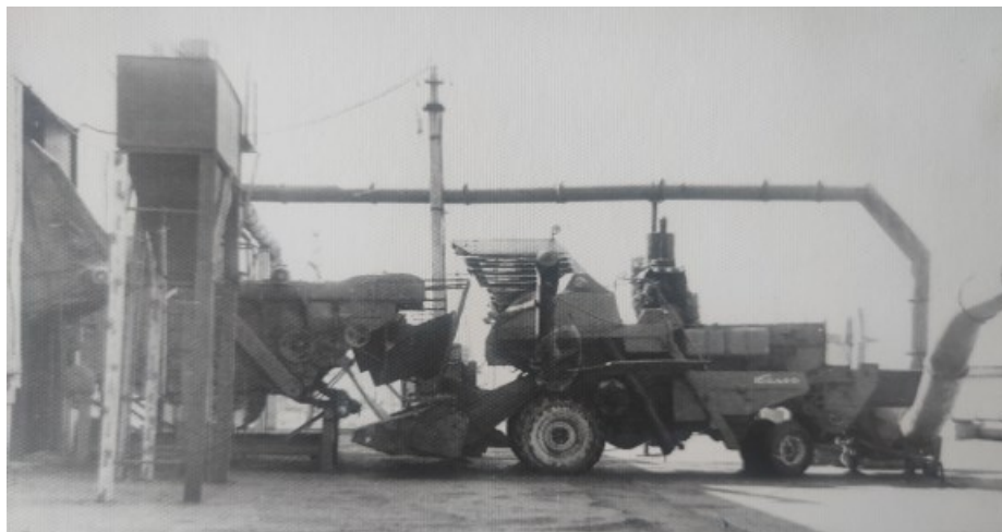
Рис. 4. Стационарная линия, включающая дозатор, сепаратор, стационарный комбайн и пневмоконвейеры
