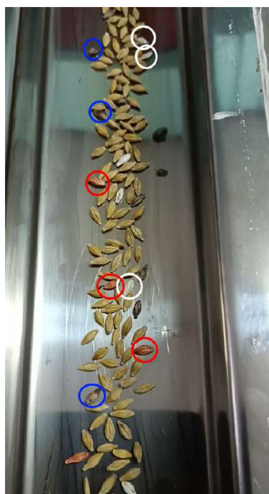
Рис. 9. Оценка поперечного смещения зерновок при движении по вогнутой поверхности: а – исходное положение; б – положение при движении
