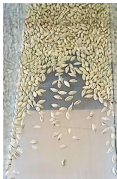
Рис. 2. Смещение зерновок к периферии
