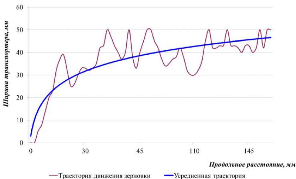
Рис. 3. Траектория движения зерновки
