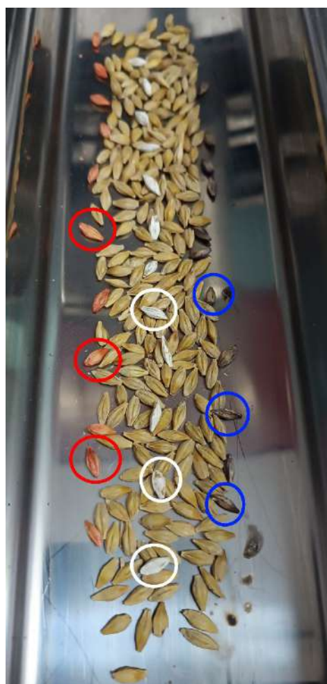
Рис. 9. Оценка поперечного смещения зерновок при движении по вогнутой поверхности: а – исходное положение; б – положение при движении
