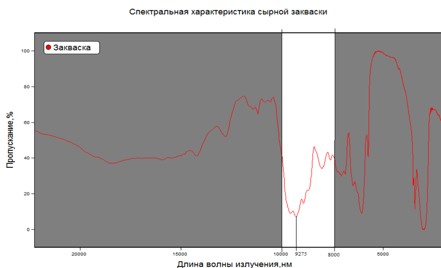
Рис. 5. Согласование спектральной характеристики и рабочего диапазона излучателя
