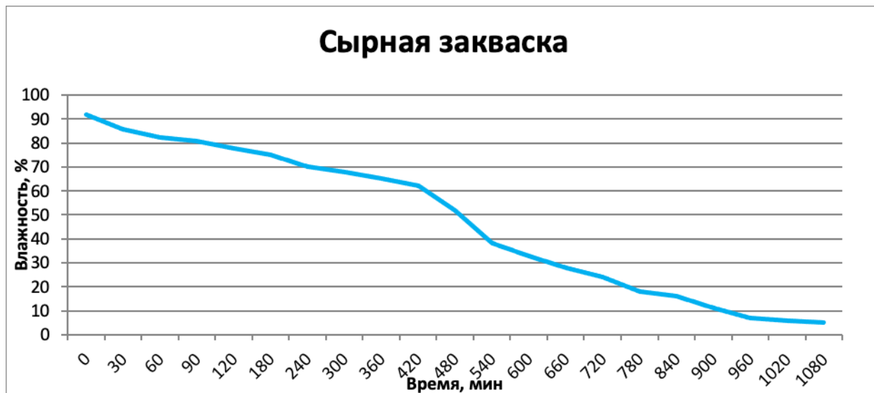
Рис. 3. Кривая влажности продукта, полученная в ходе проведения эксперимента
