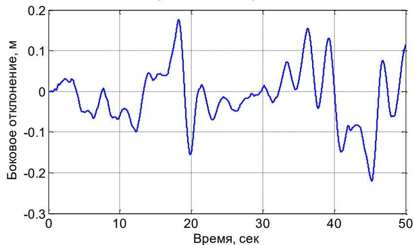
**Рис. 4. Зависимость бокового отклонения центра масс трактора от времени**
