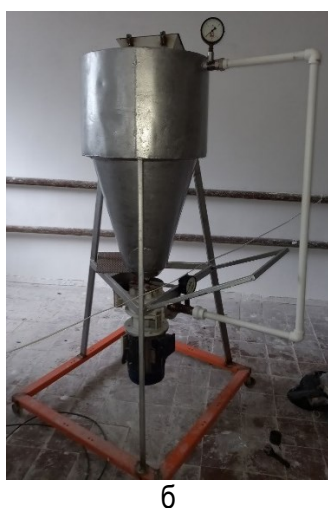
Рис. 1. Установка для приготовления зерновой патоки с трубчатым измельчителем: а – схема, б – фотография; 1 – бак, 2 – насос, 3 – сливной кран, 4 – обводной канал с трубчатым измельчителем, 5 – загрузочный люк; 6 – рама
