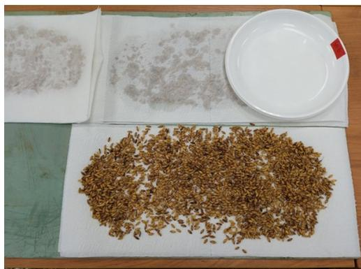
**Рис. 7. Пример удаления поверхностной влаги с семян ячменя за счет контакта с влагопопитывающей поверхностью**
