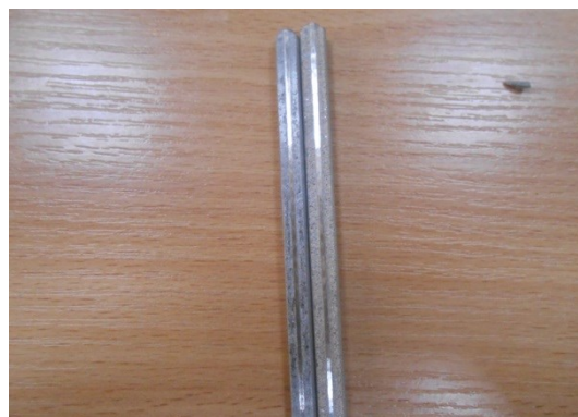
Рис. 2. Фрезерованные электроды ЦЛ11 и МРЗ
