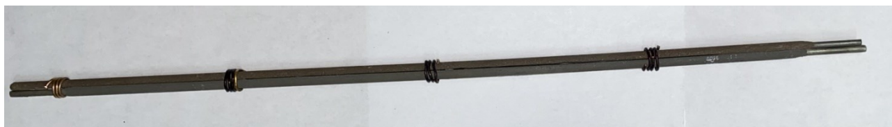
Рис. 3. Сдвоенный электрод, состоящий из двух стержневых электродов (частей) ЦЛ11 и МРЗ
