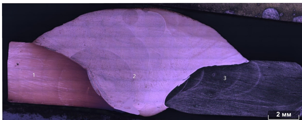
Рис. 8. Сварной шов: 1 – сталь 12Х18Н9Т; 2 – сварной шов; 3 – сталь 10
