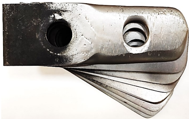
Рис. 1. Внешний вид изношенных молотков всех 8 секций одной стопки (наработка 135-145 т)
