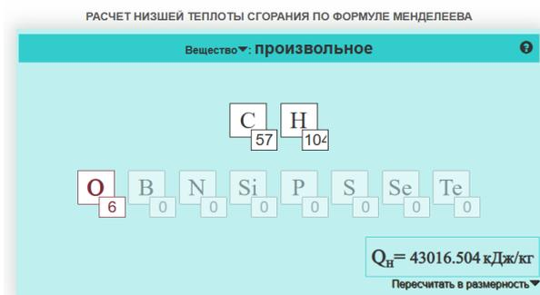
**Рис. 1. Внешний вид интерфейса рабочей панели «он-лайн» калькулятора с примером расчета величины низшей теплоты сгорания триглицерида олеиновой кислоты**
