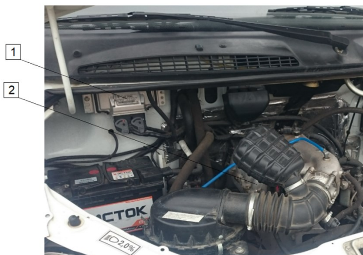
Рис. 3. Расположение ЭБУ автомобиля ГАЗель старого образца
