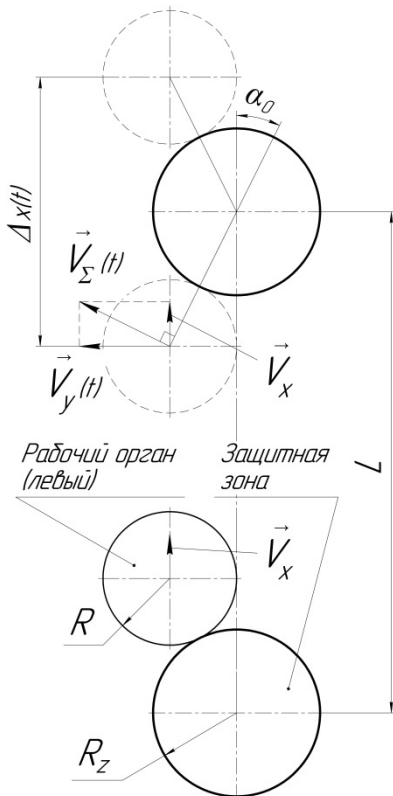
Рис. 1. Схема движения левого рабочего органа (общий вид)
