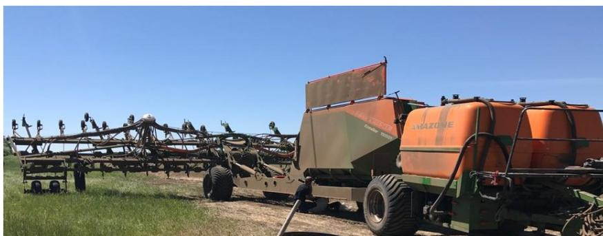
Рис. 4. Посевной комплекс Condor 15000 с емкостью для внесения жидких удобрений
