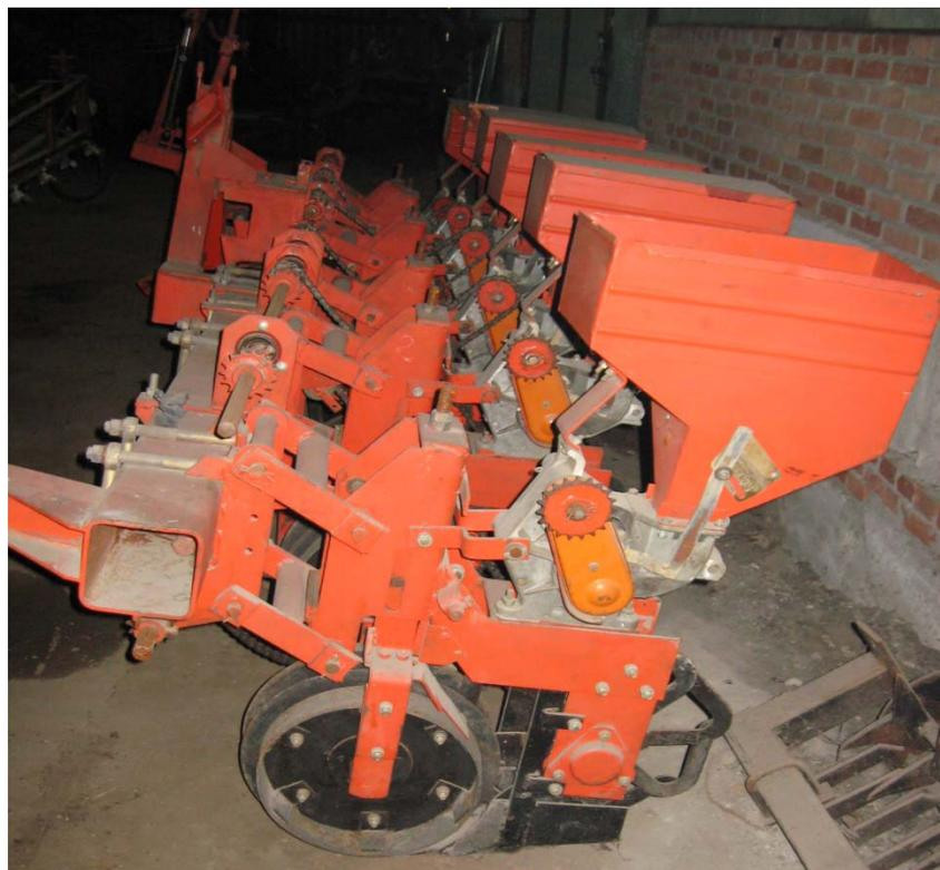
**Рис. 1.** Комбинированная машина для предпосевной обработки почвы и посева
