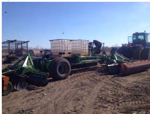
Рис. 9. Переоборудование дисковой бороны «Catros» для внесения почвенных гербицидов
