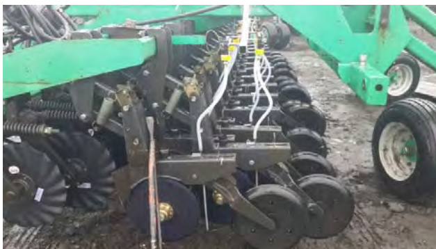
Рис. 6. Переоборудование посевного комплекса для внесения жидких удобрений
