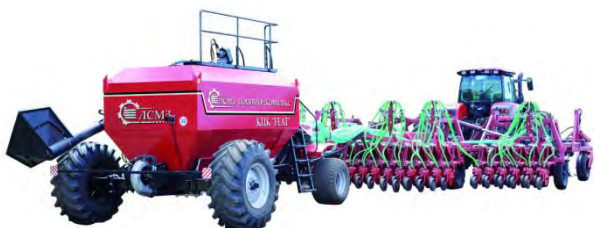
Рис. 4. Комбинированный посевной комплекс производства ООО «Леньковский «СельМашЗавод»
