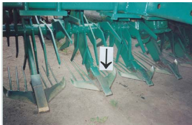
Рис. 3. Подрезающе-подъемные рабочие органы рыхлительно-сепарирующей почвообрабатывающей машины
