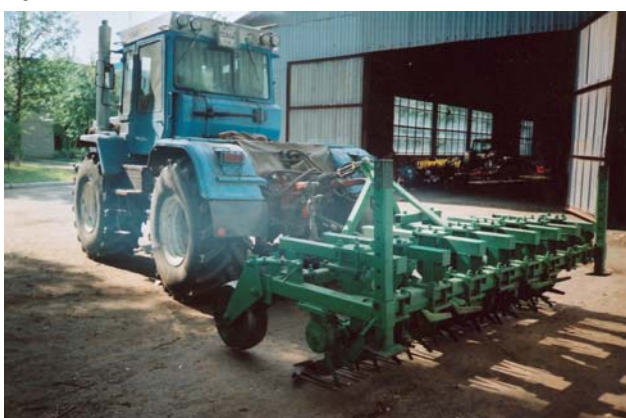
Рис. 1. Общий вид роторной рыхлительно-сепарирующей почвообрабатывающей машины
