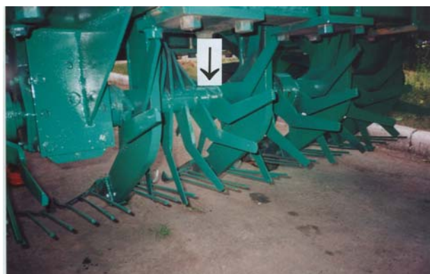
Рис. 2. Ротор рыхлительно-сепарирующей почвообрабатывающей машины
