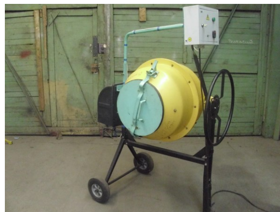
Рис. 2. Биоактиватор фуражного зерна на основе штурвального бетоносмесителя: с пультом автоматического периодического включения привода и герметичной крышкой на горловине барабана
