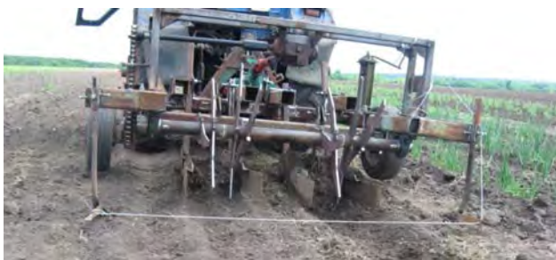
Рис. 3. Общий вид установки для поверхностной обработки почвы с тросом
