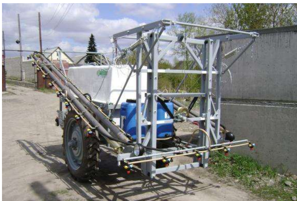
Рис. 9. Опрыскиватель полуприцепной штанговой ОПШ «Алтай 3000», ООО «ХимАгроТех»
