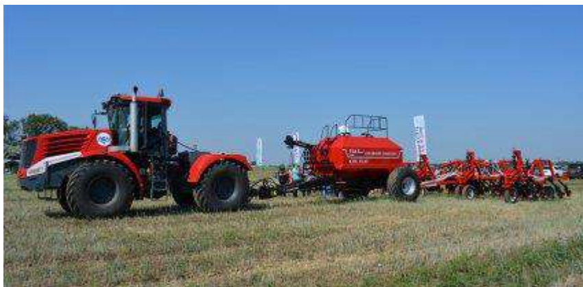
Рис. 6. Комбинированный посевной комплекс FEAT, ООО «Агроцентр»
