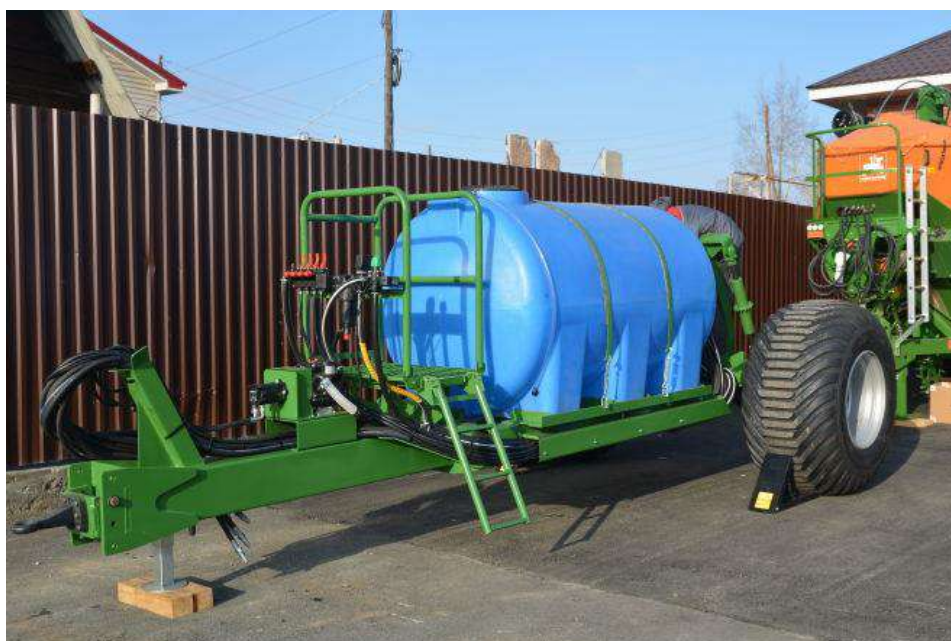
Рис. 7. Универсальный прицеп для внесения жидких удобрений, 4000 л, ООО «ТД Комплекс Агро»
