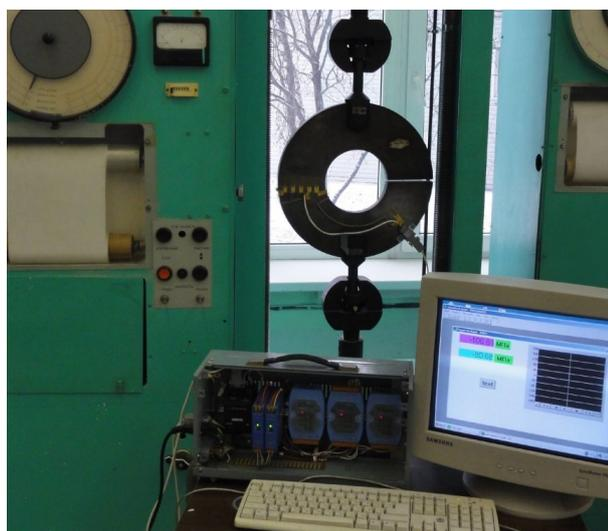
Рис. 6. Экспериментальная установка на базе разрывной машины Р-50
