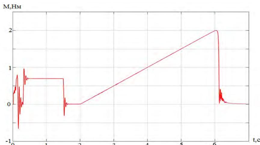
**Рис. 16. Осциллограмма крутящего момента вала электродвигателя при пуске и работе под нагрузкой**
