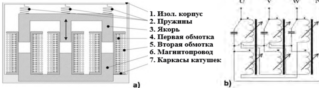
Рис. 1. Электромагнитное симметрирующее устройство с саморегулируемой индуктивностью
