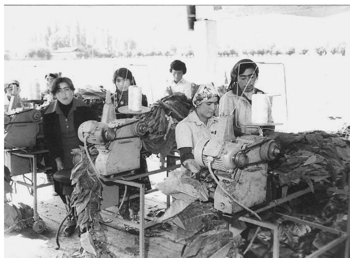
*Рис. 2. Машинное закрепление листьев табака на шнуры*
