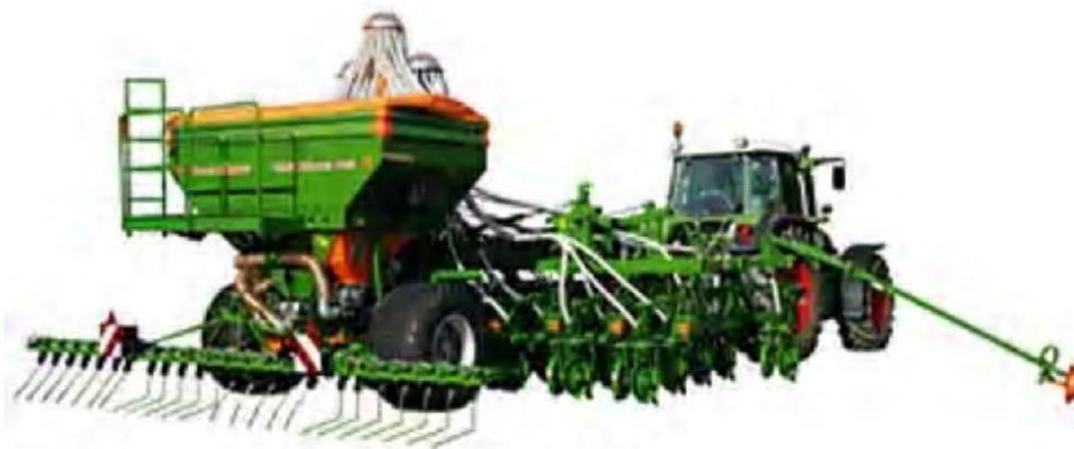
Рис. 2. Посевной агрегат на базе сеялки DMC-6000
