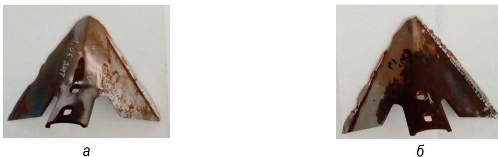
Рис. 4. Неравномерное изнашивание наплавленного слоя на крыльях стрелчатой лапы: а – сколы вдоль крыла лапы; б – осыпание, выкрашивание наплавленного слоя
