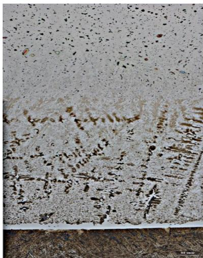
**Рис. 2. Микроструктура упрочняющего покрытия (200<sup>x</sup>), полученного из нового материала индукционной наплавкой на сталь 65Г**
